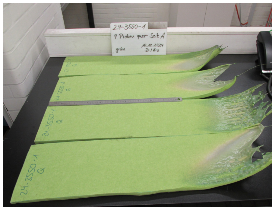
Bild 2: Aussehen der Proben nach dem Brandversuch
